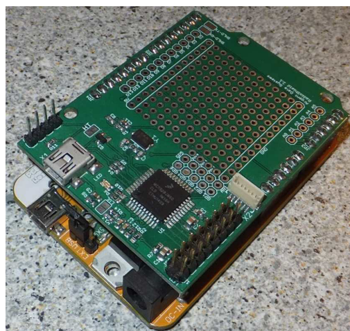
Figure 3, carte Radioshield connectée à la carte Arduino
