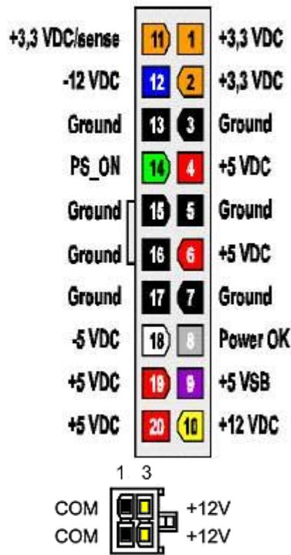
D'un connecteur à un autre, les couleurs peuvent un peu changer. Mais le brochage est identique. On constate du 3,3V, du 5V, du 12V et également des **tensions négatives**.
