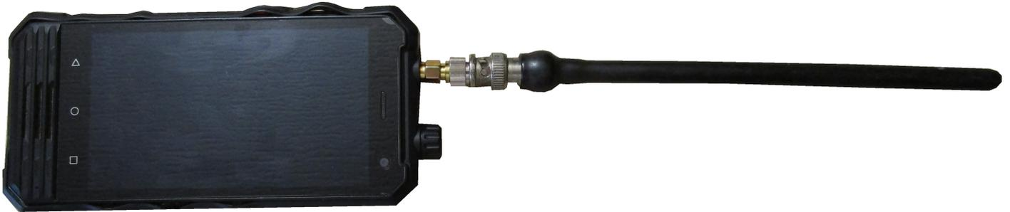
Dans ce document, je détaille la fonction talki-walki du téléphone NOMU T18. En effet, c'est un téléphone équipé d'un émetteur totalement indépendant des circuits GSM, WI-FI, Bluetooth. C'est comme un pocket. Le connecteur d'antenne est une SMA femelle. Le commutateur sur le dessus permet de changer le canal mémoire.
